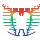
Módulo led tipo C P: 156W, Ta: 40°C, Tmáx: 66°C
