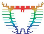
Módulo led tipo D P: 196W, Ta: 40°C, Tmáx: 66°C
