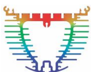
Módulo led tipo D P: 196W, Ta: 40°C, Tmáx: 66°C
