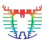
Módulo led tipo C P: 156W, Ta: 40°C, Tmáx: 66°C
